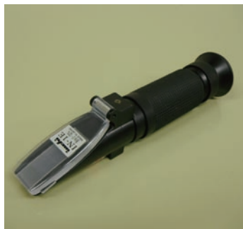
写真2. 手持屈折糖度計(比重計のように温度を気にせず1~2滴で測定可能。13000円前後で購入できます)
